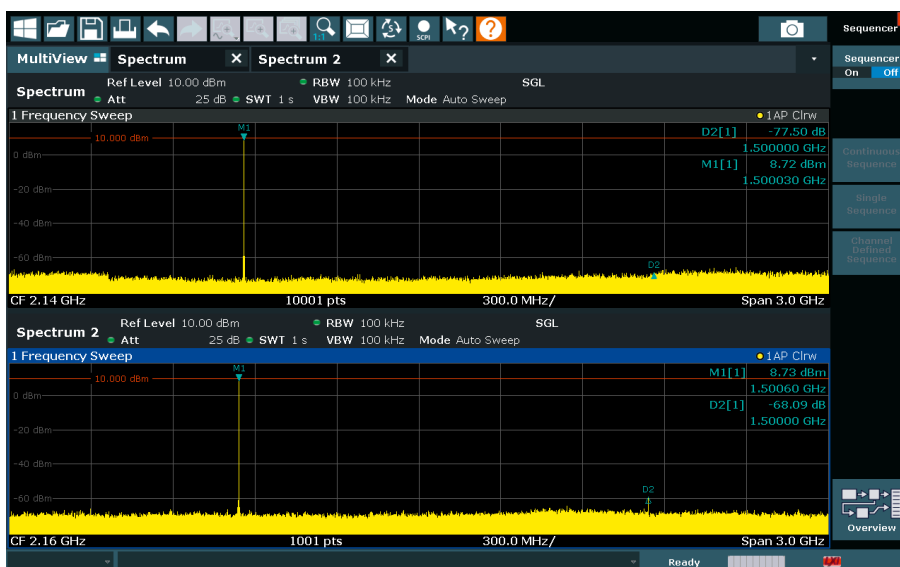
Измерение гармоник с включенным (сверху) и выключенным (снизу) фильтром высоких частот
